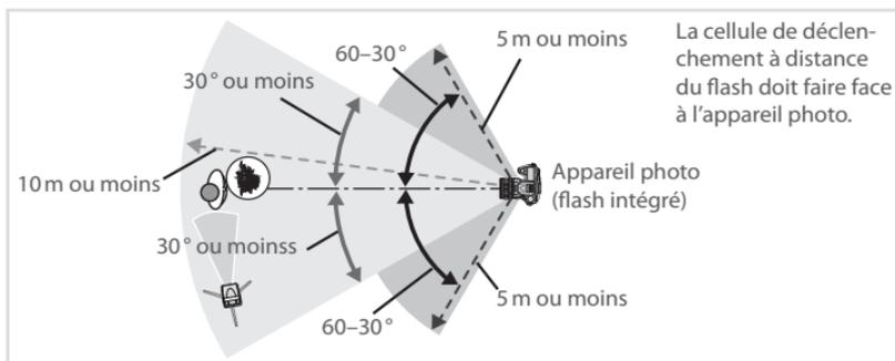
La distance maximale entre le flash optionnel et l'appareil photo est d'environ 10 m lorsque le flash est placé devant l'appareil photo (30° ou moins d'un côté ou de l'autre de la ligne centrale) ou d'environ 5 m lorsque le flash est placé entre 30 et 60° d'un côté ou de l'autre de la ligne centrale.
