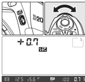
Pour rétablir la puissance de flash standard, réglez la correction d'exposition sur  $\pm 0,0$  et effectuez une réinitialisation par deux commandes
