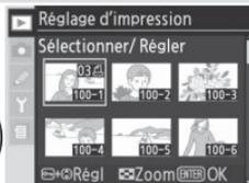
Appuyez sur la commande **⊞** puis en haut ou en bas du sélecteur multidirectionnel pour préciser le nombre d'impressions (jusqu'à 99). Vous pouvez également appuyer au centre du sélecteur multidirectionnel pour sélectionner l'image et définir le nombre d'impressions sur 1. Les images sélectionnées sont signalées par l'icône
