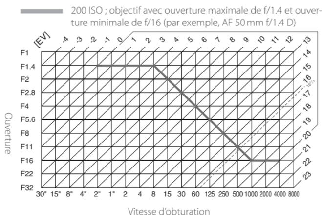
Les valeurs maximales et minimales de l'incrément d'exposition varient en fonction de la sensibilité (équivalence ISO). Le graphique ci-dessus se base sur une sensibilité de 200 ISO. En cas d'utilisation de la mesure matricielle, les valeurs supérieures à 16 2/3 IL sont réduites à 16 2/3 IL.
