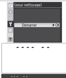
**3** Appuyez complètement sur le déclencheur. Le miroir est levé et l'obturateur s'ouvre, révélant le filtre passe-bas, et la rangée de tirets clignote sur l'écran de contrôle. L'affichage dans le viseur s'éteint.
