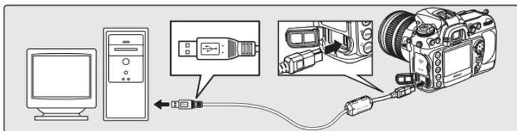
4 Mettez l'appareil photo sous tension. Si **Stockage de masse** est sélectionné comme option **USB, P $\square$**  apparaît sur l'écran de contrôle et dans le viseur, et l'indicateur de mode PC clignotera (si **PTP** est sélectionné, les écrans de l'appareil photo ne changeront pas). Les photos peuvent être transférées vers l'ordinateur comme décrit dans le manuel accompagnant le logiciel fourni (sur CD-ROM).
