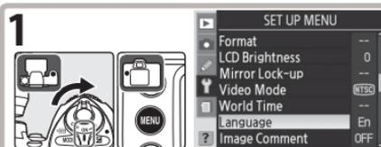
Mettez l'appareil photo sous tension et appuyez sur la commande **MENU**.
