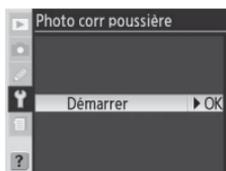
**1** Fixez un objectif à microprocesseur sur l'appareil photo (un objectif avec une focale d'au moins 50 mm est recommandé). L'option **Photo corr poussière** est disponible uniquement pour les objectifs avec microprocesseur. Si vous utilisez un zoom, zoomez en position de téléobjectif maximal.
