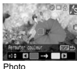
**3 Visez le sujet avec l'appareil photo de façon à ce que la couleur d'origine s'affiche au centre de l'écran LCD et appuyez sur la touche ↪.**
