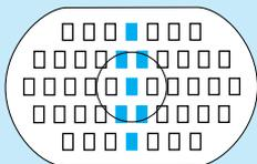
(1) Avec des objectifs d'une ouverture maximale de  $f/2.8$  ou plus (faible nombre  $f$ ), les collimateurs autofocus en surbrillance sur la figure se transforment en capteurs en croix et ils deviennent sensibles à la fois aux lignes horizontales et aux lignes verticales. Les 38 collimateurs restants ne sont sensibles qu'aux lignes horizontales. La sensibilité aux lignes verticales des capteurs en croix est trois fois supérieure à la sensibilité aux lignes horizontales.
